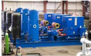
Bomba de calor
