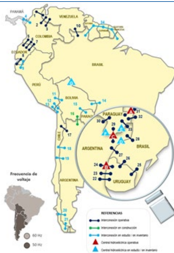
Figura 2: Interconexiones eléctricas internacionales y centrales binacionales
